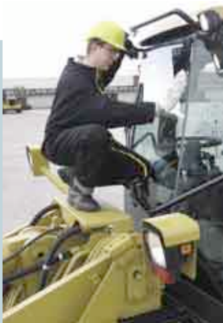
Pridavné stúpadlá a rebríky na prístup k predným oknám
