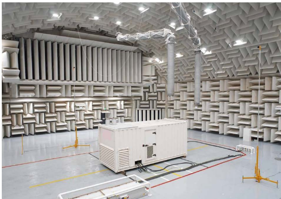
Vývojové centrum závodu Larne disponuje najväčšou európskou zvukovou komorou, kde sa uskutočňujú merania hluku motorov a generátorov.
