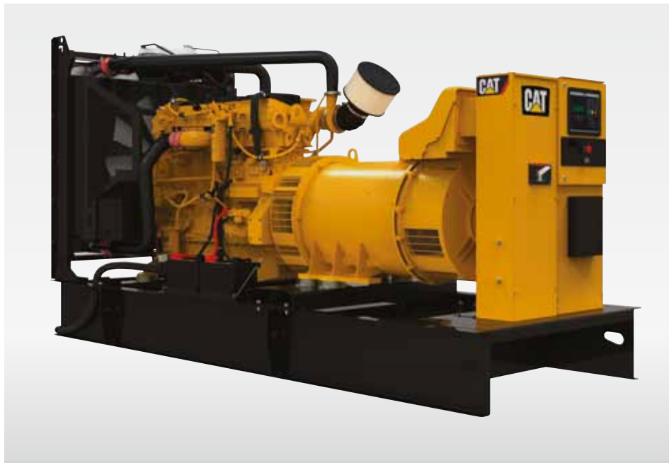
Caterpillar C18 – nové modely s výkonom 780 a 850 kVA majú nádrž s objemom 1700 litrov, čo postačí na 10 hodín činnosti. Vrchná časť nádrže predstavuje záchytný priestor, v ktorom sa uchovávajú prípadné úniky kvapalín
