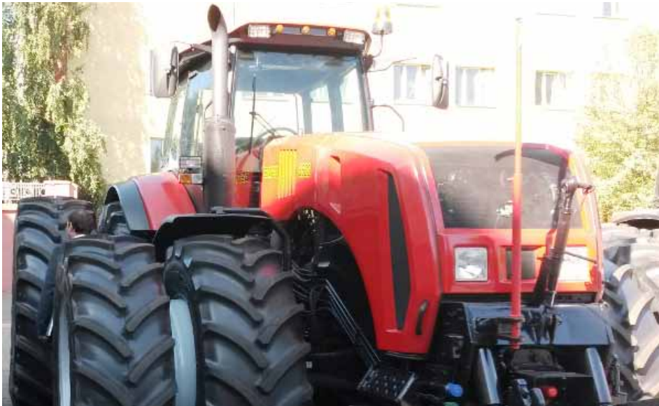
Traktor radu 3522 Belarus s motorom Cat C9 ACERT
