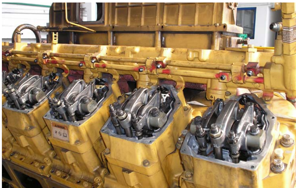
Pri generálnej oprave motora CAT 3512B sa použije vyše 700 kusov originálnych náhradných dielov Cat
